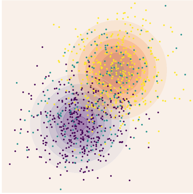
FIGURE 2.2 – Mélange de deux gaussiennes de covariance scalaire en dimension 2. Les points verts correspondent aux points sans étiquette, étudiés dans le cas général semi-supervisé.
